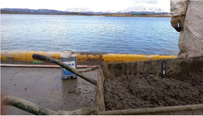
Fotografías de toma de temperatura y contenido de aire del hormigón fresco
