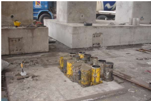
Moldeo de probetas y curado a un costado de la estructura (mismas condiciones)
