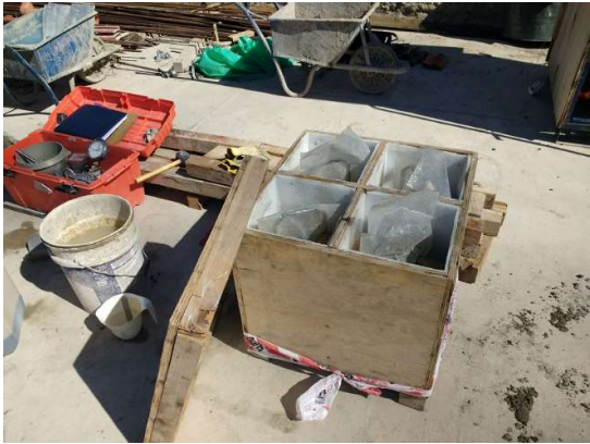
Protección específica de probetas de las bajas temperaturas (primeras 24 hs y luego curado)
